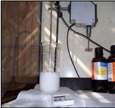
Añadir 10mL de isopropanol y continuar con la agitación en hélice pero disminuyendo la velocidad (200rpm/4 horas).
