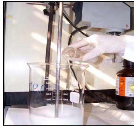
Incorporación de la 1ra emulsión (A 1 /O) a la Fase A 2 (A 1 /O/A 2 ) Agitación en sistema de Hélice a 800rpm/30min.
