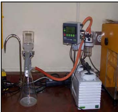
Filtración con bomba de vacío
