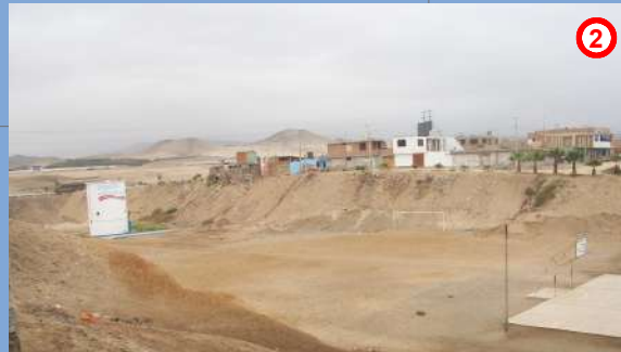
2 Zona I conformada por depósitos coluvial-aluvial con medidas de vibración ambiental entre 0.1 y 0.2s, se caracterizan por el comportamiento rígido del suelo. Registro fotográfico (23 de setiembre del 2017, distrito de Punta Negra).
