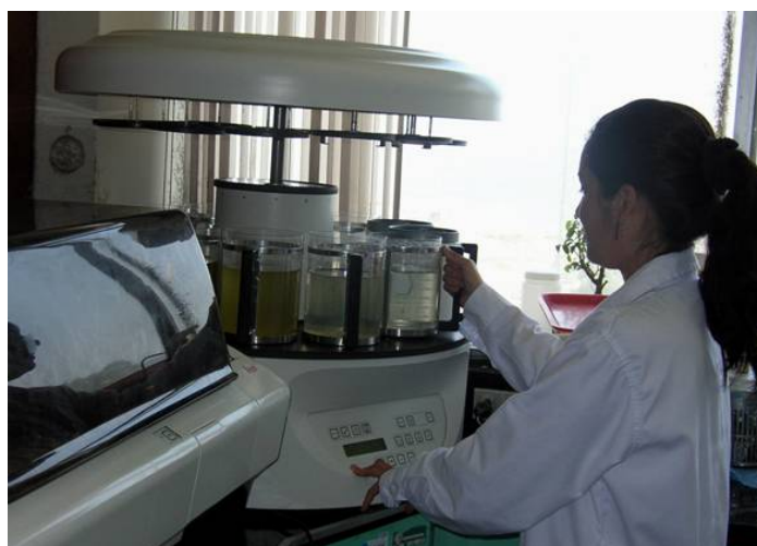
Foto 4. Procesamiento de las muestras de gónada en el procesador automático de tejidos.
