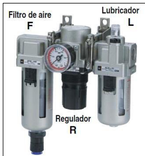
Figura 2.15 Unidad de mantenimiento FRL.
