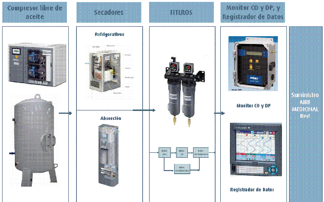
Fig. 14 Flujo en un Sistema de Aire Medicinal
