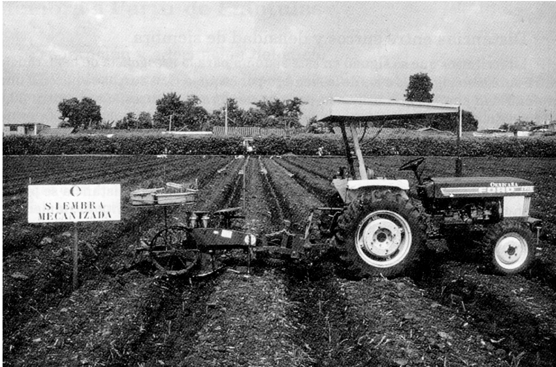
Figura 3.3. Transplante mecanizado de plántulas de caña de azúcar utilizando una máquina “Mechanical Transplanter Co.”, modelo 4000.
