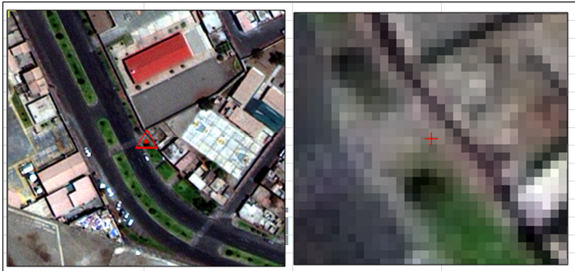
Figura 49. GCP ILO_03 en la imagen orto rectificada. Fuente. Datos tomados de “GeoService Perú” (2014)
