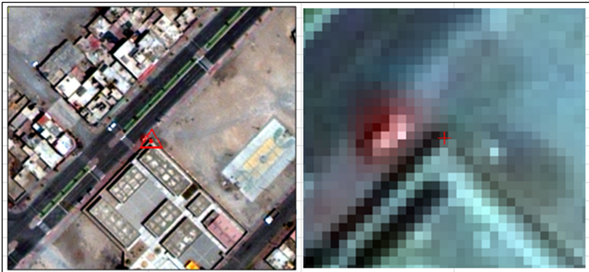
Figura 53. GCP ILO_08 en la imagen orto rectificada. Fuente. Datos tomados de “GeoService Perú” (2014)
