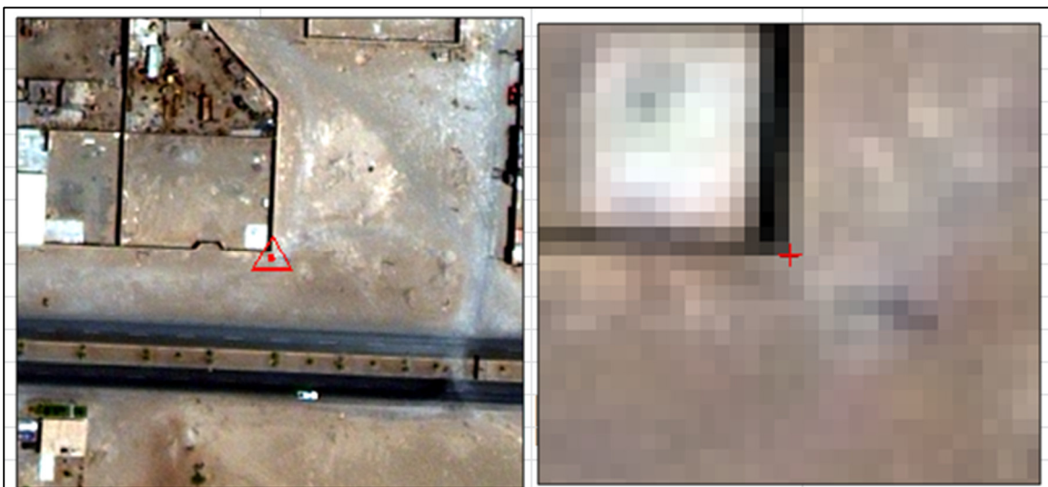
Figura 54. GCP ILO_09 en la imagen orto rectificada. Fuente. Datos tomados de “GeoService Perú” (2014)
