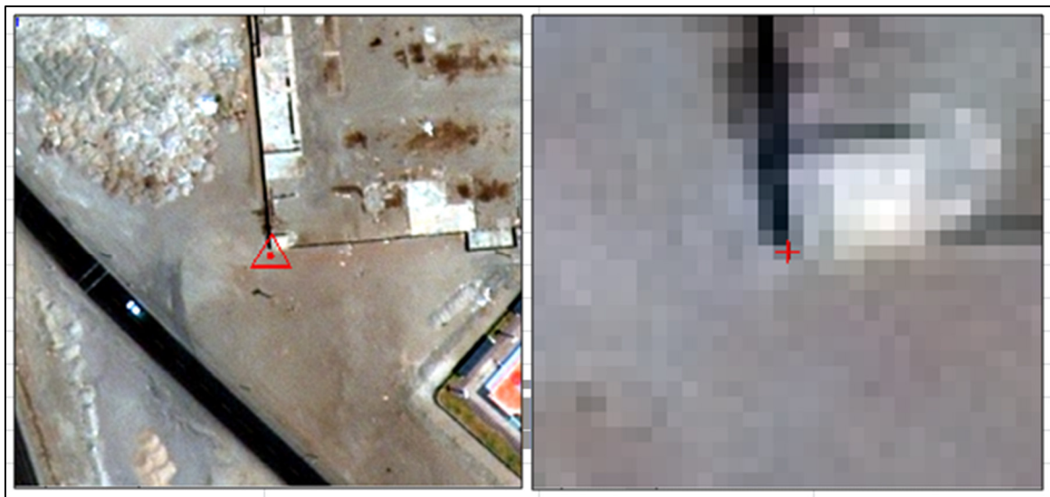
Figura 50. GCP ILO_05 en la imagen orto rectificada. Fuente. Datos tomados de “GeoService Perú” (2014)
