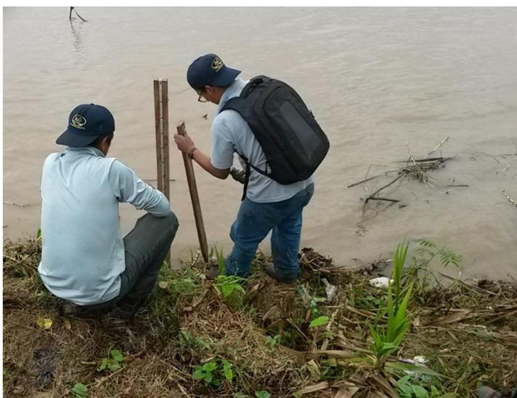
Fotografía 3.3. Instalación de reglas limnimétricas para la medición de niveles de río.
