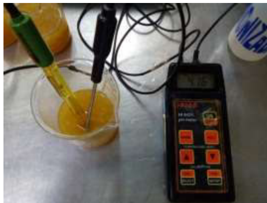
Figura 40: Medición de pH en muestras de bebida de quinua.
