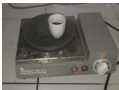
Figura 42: Carbonización de la muestra con ácido sulfúrico en una plancha calefactora
