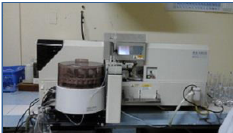
Figura 15. Equipo de A.A. utilizado en éste estudio para análisis de arsénico y cadmio Fuente: Elaboración propia.
