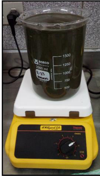
Anexo 9. Homogenización del elutriado.
