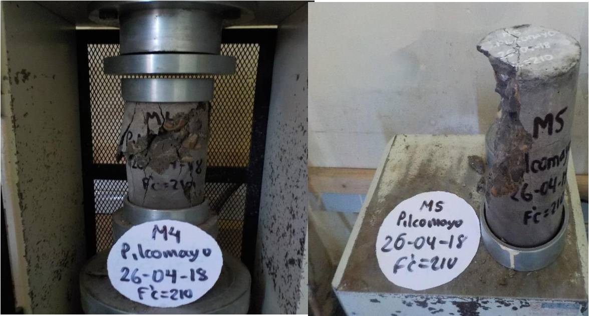
Figura N° 23: Vista de la rotura de espécimen con F'C=210 kg/cm 2 con agregado grueso de baja intemperización
