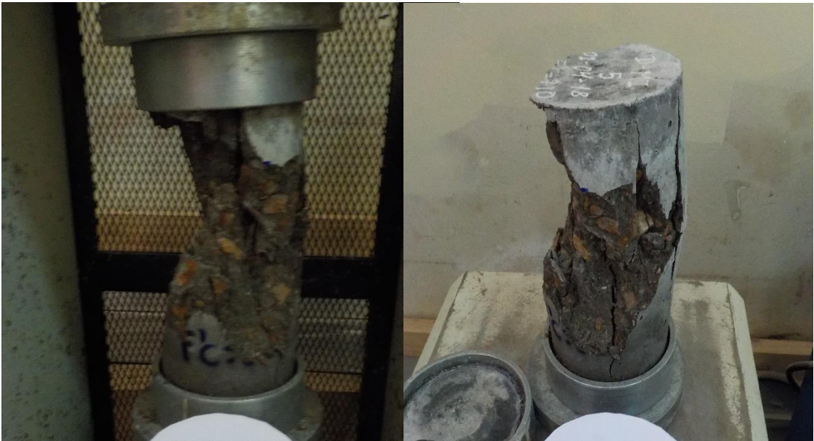
Figura N° 24: Vista de la rotura de espécimen con F'C=210 kg/cm 2 con agregado de media intemperización
