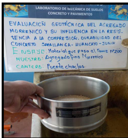
Figura N° 11: Material Que Pasa Por La Malla N°200
