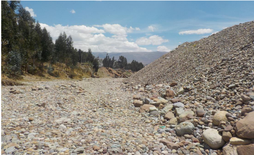
Figura N° 30: Material morrénico dentro del cauce del río Chaclas – Sapallanga, que no es utilizado para agregados (agregado subanguloso).
