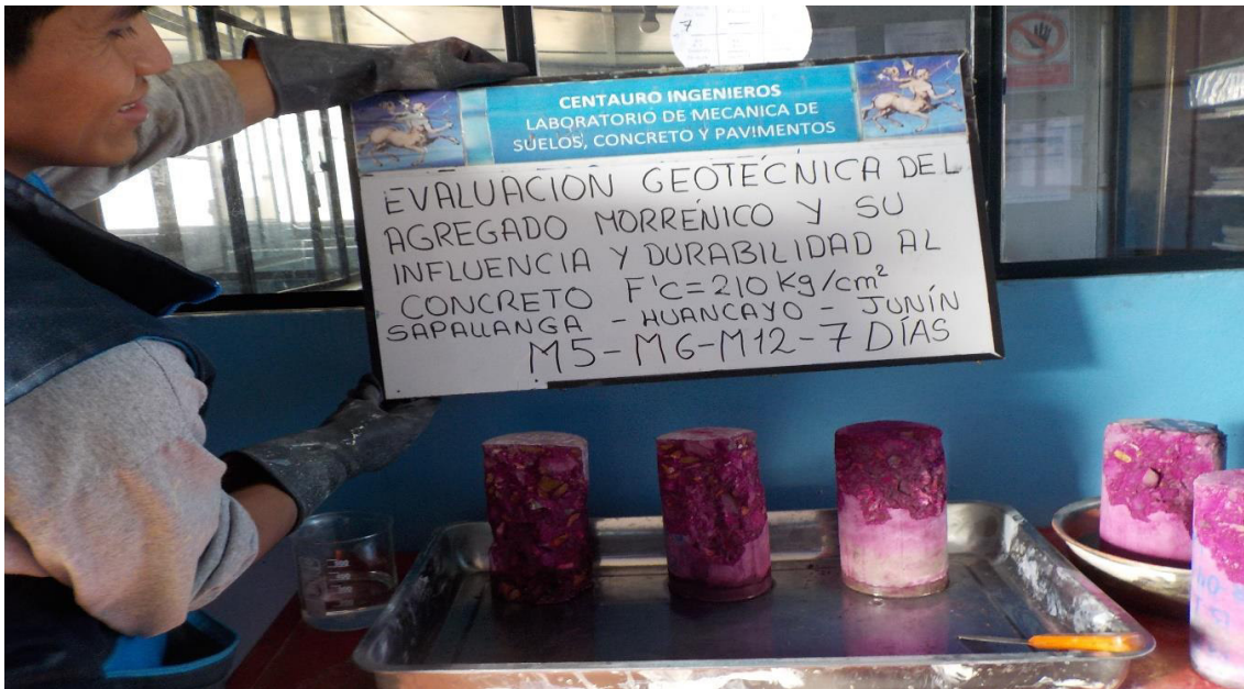
Figura N° 21: Vista del ensayo De Carbonatación de los especímenes con F'C=210 kg/cm 2 con agregado grueso de alta intemperización
