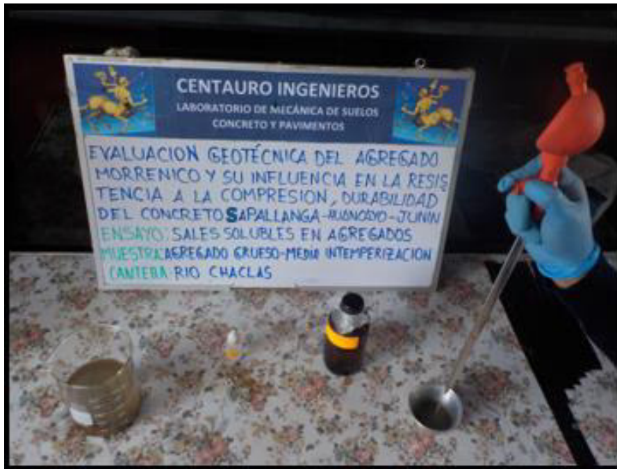
Figura N° 16: Sales Solubles En El Agregado Grueso
