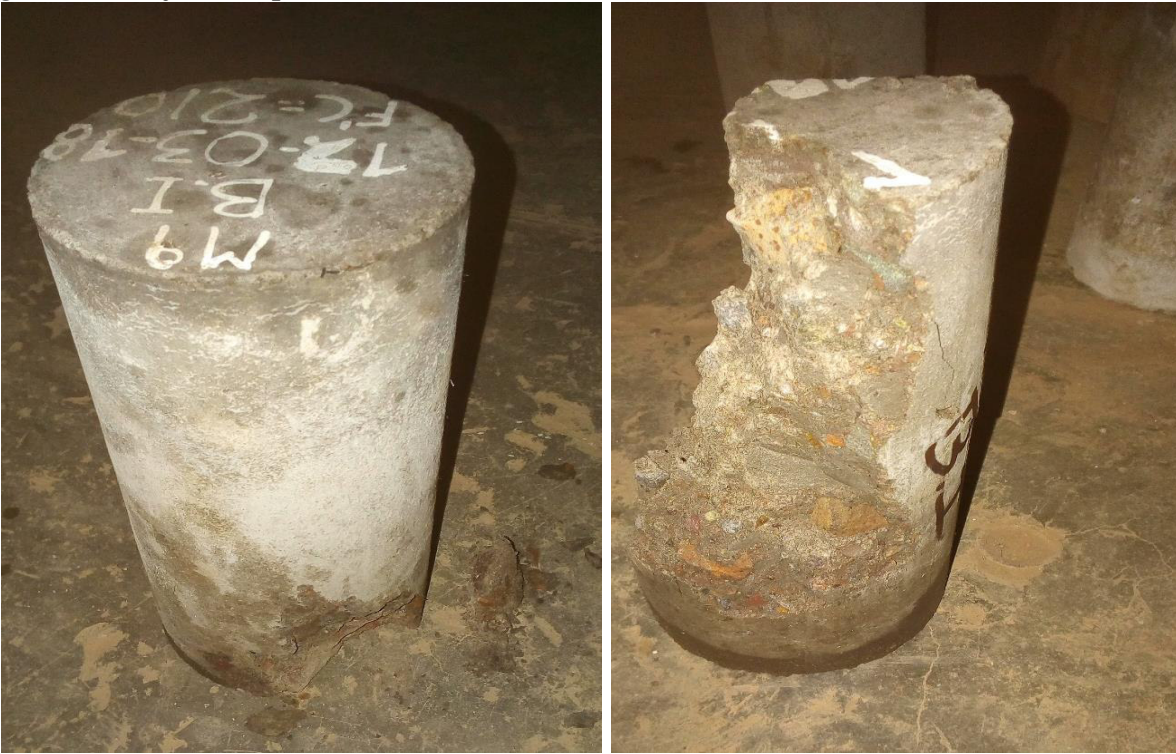
Figura N° 23: Vista de la rotura de espécimen con F'C=210 kg/cm 2 con agregado grueso de baja intemperización
