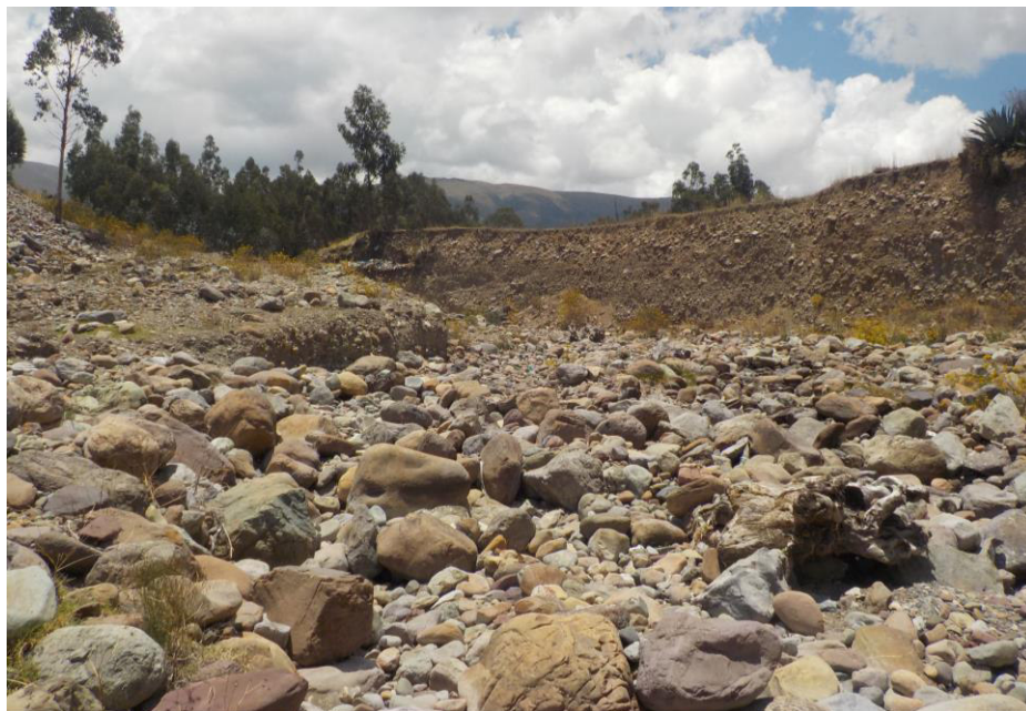
Figura N° 30: Material morrénico dentro del cauce del río Chaclas – Sapallanga, que no es utilizado para agregados (agregado subanguloso).
