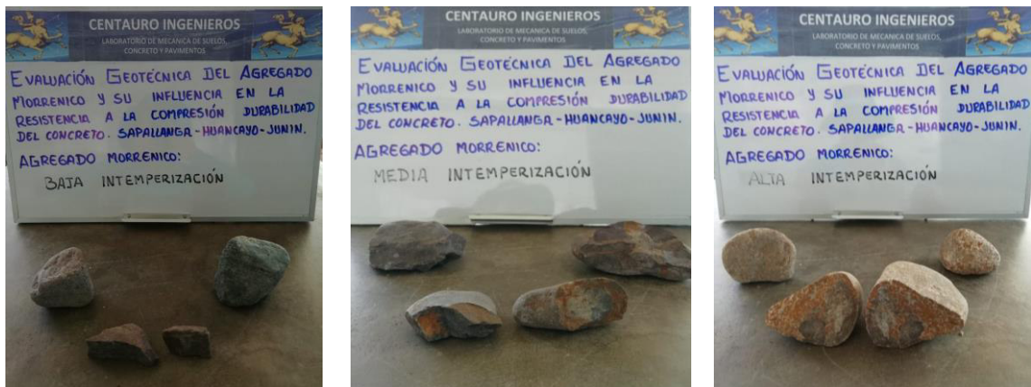
Figura N° 4: Agregado De La Cantera De Sapallanga – Morrénico E Intemperizado
