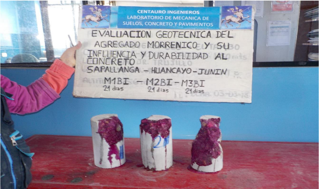
Figura N° 19: Vista del ensayo de Carbonatación de los especímenes con F'C=210 kg/cm 2 elaborado con agregado grueso de baja intemperización
