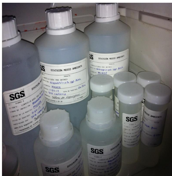
Figura 27 frascos de envase polimérico con muestras (para aniones, cationes y gases) de agua termal de san Antonio de Putina
