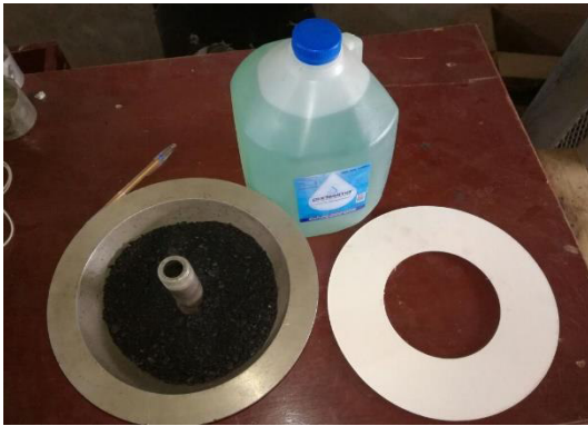
Preparación de asfalto para contenido de asfalto (gasolina, filtro, muestra)
