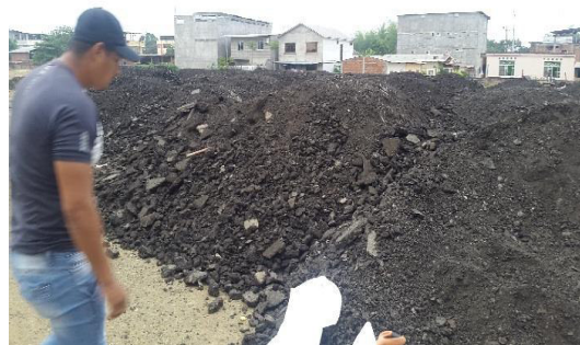
Centro de acopio de pavimento asfáltico envejecido
