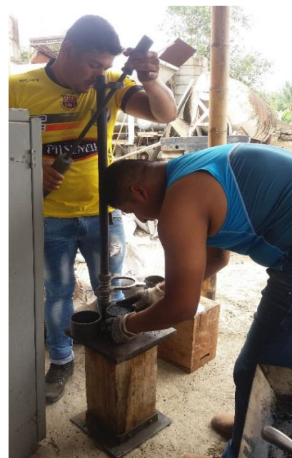
Colocación de materiales en briquetas
