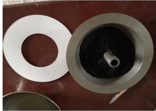
Preparación de asfalto para contenido de asfalto (gasolina, filtro, muestra)
