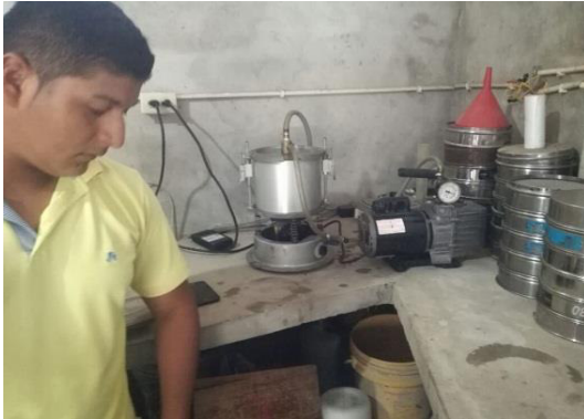
Extracción en bomba de vacío
