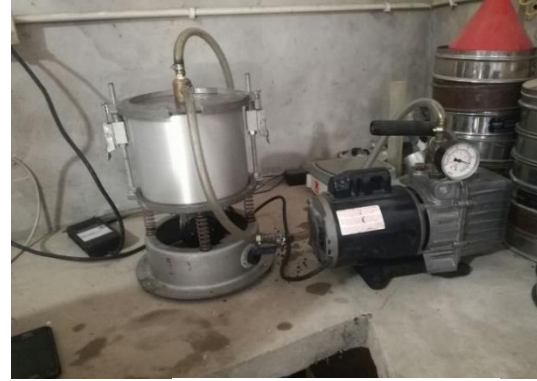
Bomba de vacío
