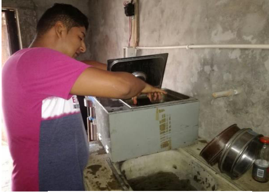
Colocación de briquetas a baño maría
