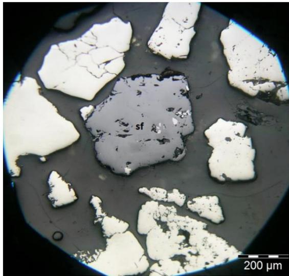
Figura 41. Micrografía del mineral Esfalerita.
