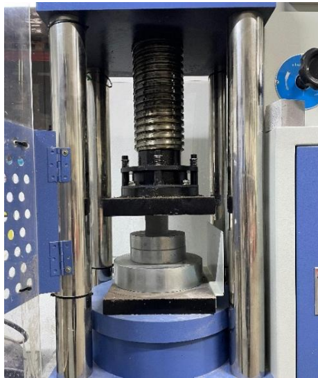
Figura 13: Ensayo de rotura a los cubos del grout 100
