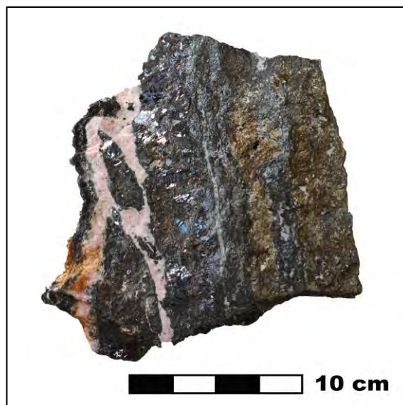
Figura 41. Muestra extraída para análisis, se observa bandeamiento de sulfuros (esfalerita, galena y pirita), también se tiene texturas crustiformes en la parte izquierda de la muestra formadas entre cristales de galena y carbonatos.
