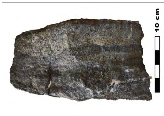
Figura 36. Muestra extraída para análisis, se observa bandeamiento de sulfuros (esfalerita, galena y pirita).
