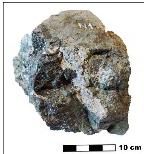
Figura 45. Muestra extraída para análisis, se observa banda de galena y esfalerita a la izquierda mientras que a la derecha la banda de pirita, la cual contiene también sulfosales.
