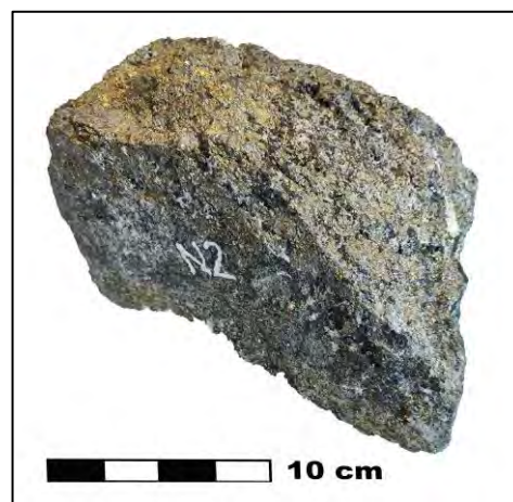
Figura 49. Muestra de mano extraída para análisis, se observa esfalerita, galena y sulfosales diseminadas en pirita.
