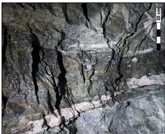
Figura 34. Veta de 30 cm, muestra bandas de galena, esfalerita, pirita y carbonatos. Se presenta alteración argílica, el halo de alteración de la veta llega a medir hasta 10 cm.
