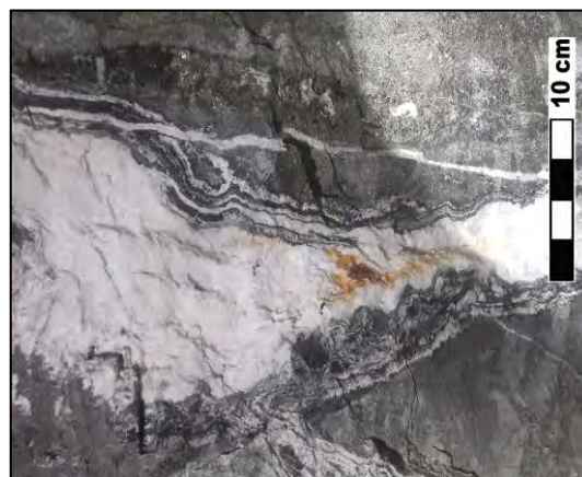
Figura 35. Texturas crustiformes y coloformes, las bandas oscuras están conformadas por marmatita y las bandas claras por calcita.
