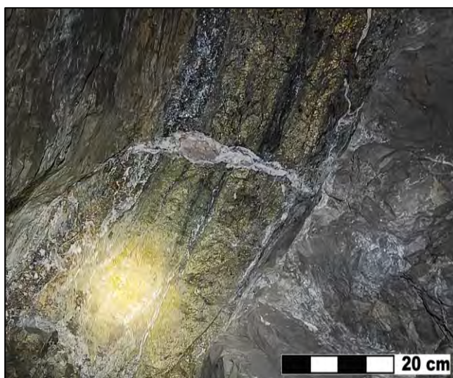
Figura 22. Falla de rumbo sinistral (izquierda) rellenada por carbonatos.
