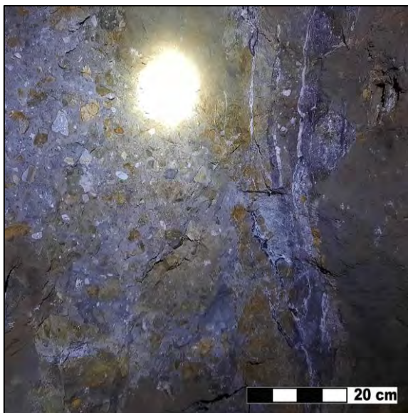
Figura 40. Brecha clasto-soportada polimíctica, los clastos van de subangulosos a subredondeados, la composición de los clastos generalmente son margas y granitos, contiene algunos sulfuros en mínimas cantidades como pirita y galena.
