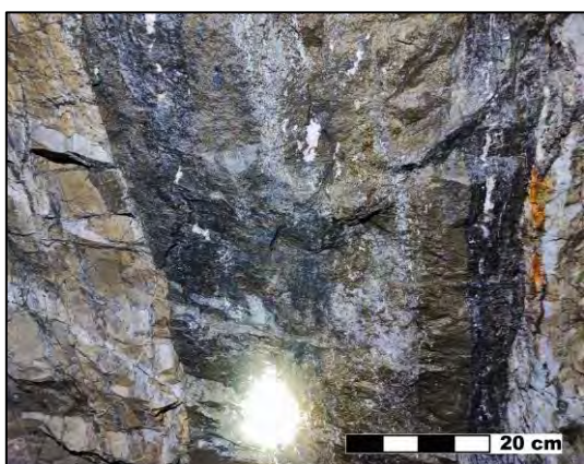
Figura 46. Veta con bandas de esfalerita y galena en los bordes mientras que la banda de pirita se presenta al medio, se aprecia poca alteración en la roca encajonante.
