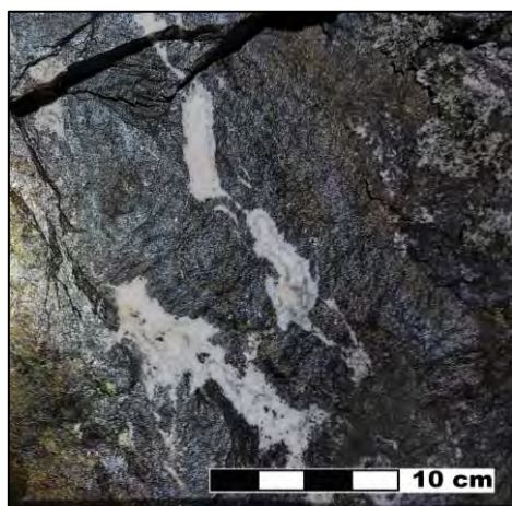
Figura 48. Texturas crustiformes y coloformes, las bandas oscuras están conformadas por marmatita y galena y las bandas claras por calcita.
