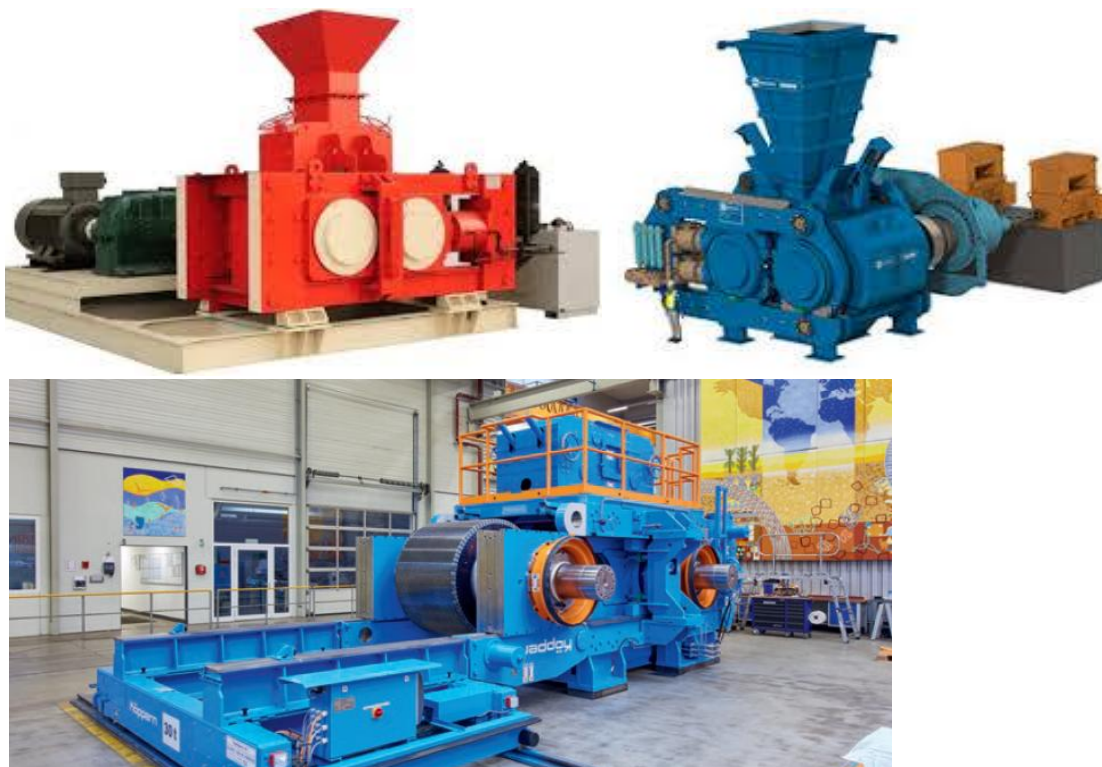
Figura 6. Ejemplos de Equipos HPGR (Arriba-Izq.: Metso / Arriba-Der.: FLSmidth / Abajo: Koppert)
