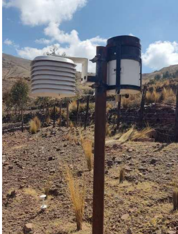
Figura 8. Estructura del pluviómetro HOBO con registrador de datos
