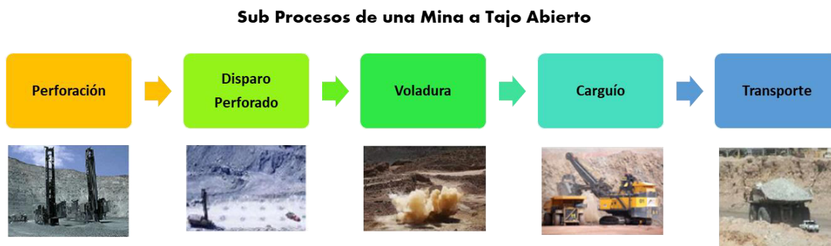
Figura 10: Procesos de una mina a tajo abierto.
