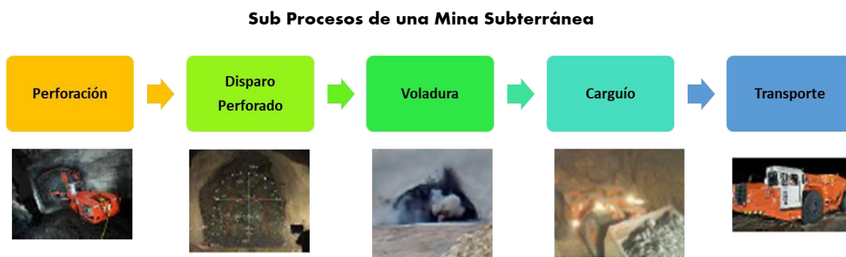
Figura 11: Procesos de una Mina Subterránea.
