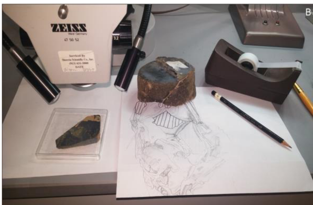
Figura 3.1: Equipo usado en el Laboratorio del museo de la Universidad de Kansas. A) Estereomicroscopio Zeiss con cámara lúcida. B) Esquema de un ejemplar fósil de pez dibujado con el Estereomicroscopio Zeiss con cámara lúcida.
