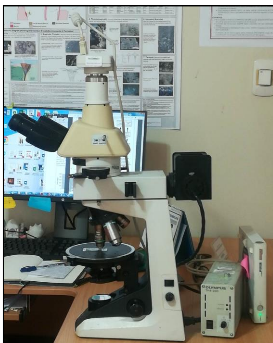
Figura N°22. Microscopio Nikon Eclipse E2000. En la margen derecha se observa cámara Nikon DS-U3. Fuente: Propia.
