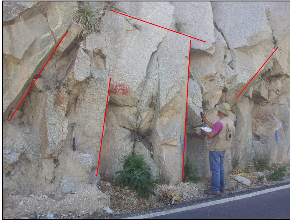
Figura N°12. Afloramiento del batolito de la cordillera Blanca. En líneas rojas se pueden observar los diversos sistemas de diaclasamiento NW-SE, NE-SW. Además, se aprecia presencia de fracturas y venillas que afectan el cuerpo intrusivo. Dirección de la foto SE-NW. (Fuente Acosta, 2015)
