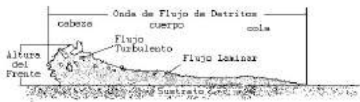
Perfil de un Frente Típico de un Flujo de Detritos
