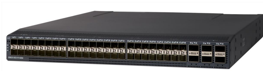
Figura 8 Vista frontal de un Cisco UCS FI 6454. Fuente. Datos tomados de Cisco Systems (2021).
