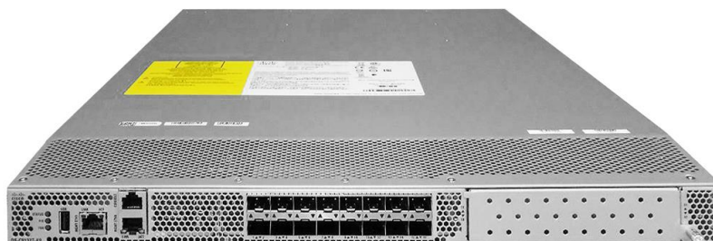
Figura 10. Vista frontal de un switch SAN Cisco MDS DS-C9132T-MEK9. Fuente. Datos tomados de Cisco Systems (2023).
