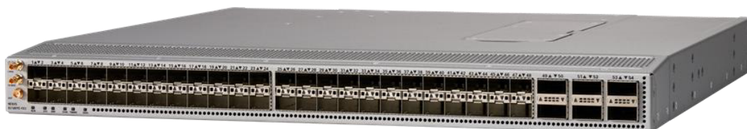
Figura 9 Vista frontal de un switch LAN Cisco Nexus N9K-C93180YC-FX3. Fuente. Datos tomados de Cisco Systems (2025b).
