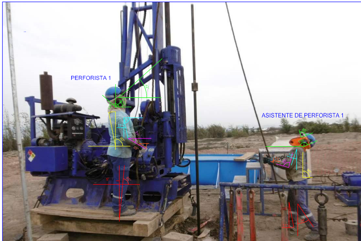
Figura 16. Proceso de Perforación. Perforista 1 y Ayudante de Perforista 1 - Evaluados
