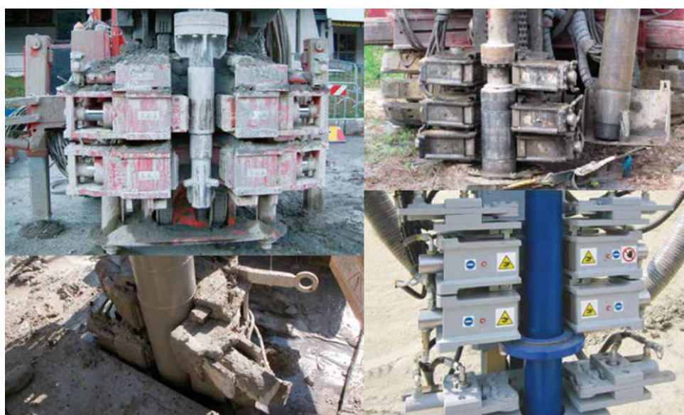
Figura 12. Sistema de Mordazas hidráulicas para Máquinas perforadoras
