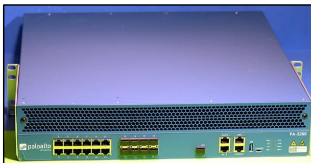
Figura 5: Firewall Palo Alto Modelo PA-3250. Fuente: Anexo 1.
