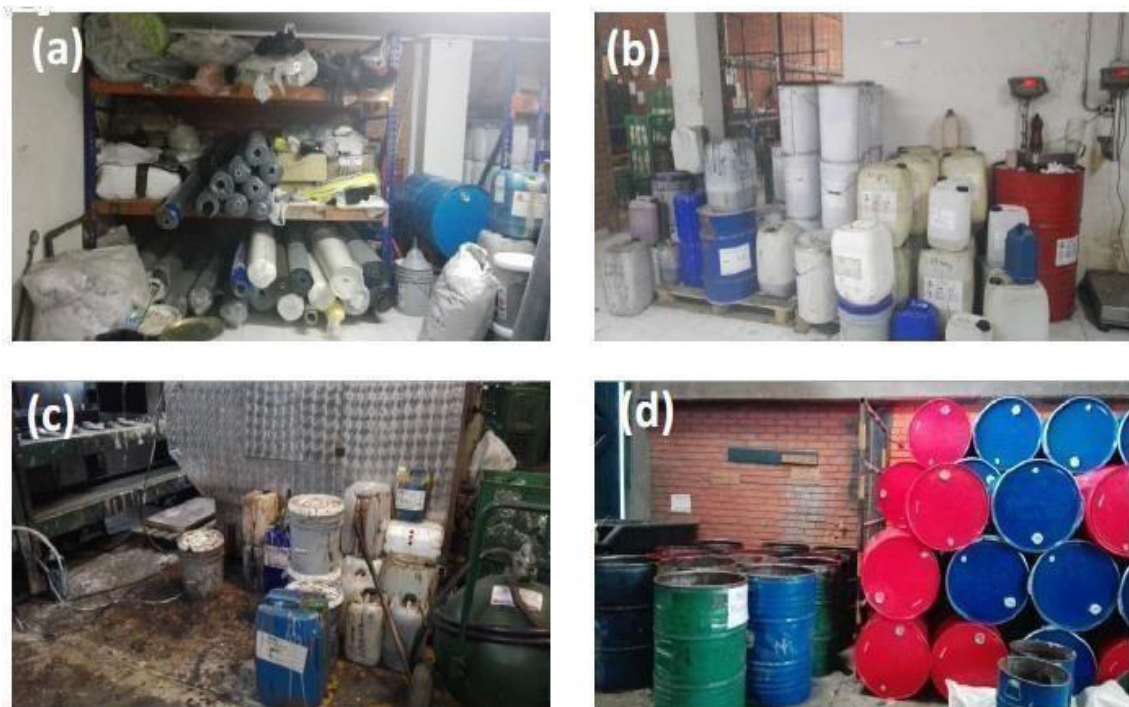
Figura 1: Condiciones de almacenamiento y manejo de sustancias químicas en la planta
