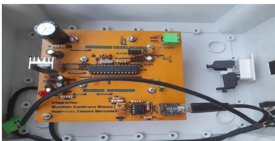
Figura 9 Placa física fabricada de forma artesanal
