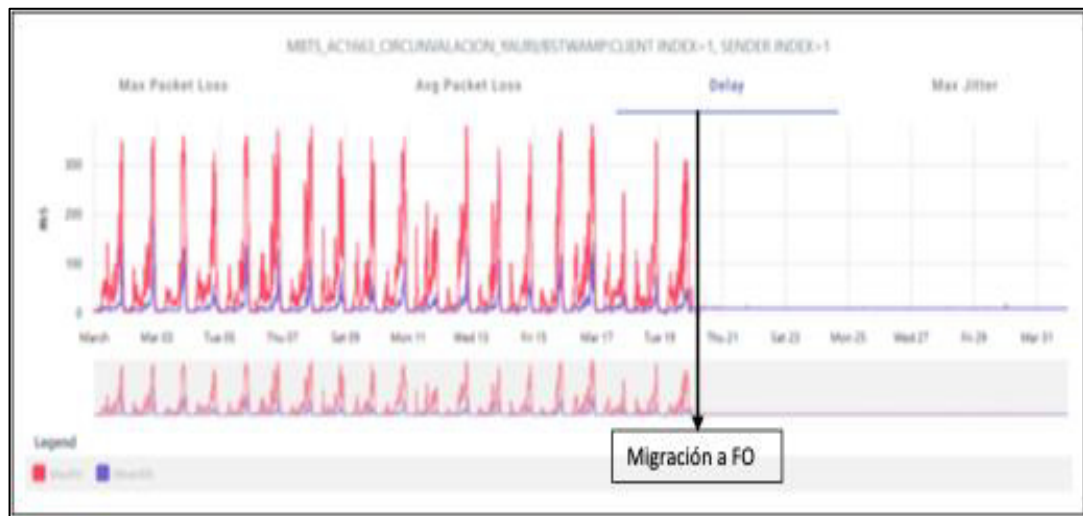
Figura 23 Medición de retardo de paquetes de Circunvalación Yauri.
