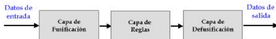
Figura 2.12 – Diagrama de bloques de un Sistema Neuro-difuso
