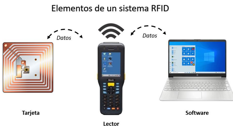
Figura 4. Elementos de un sistema RFID. Fuente: Elaboración Propia
