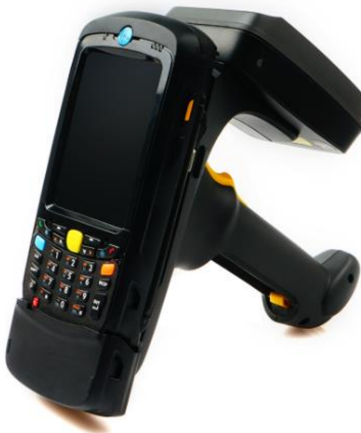
Figura 80. Lector RFID (Adaptador RFID RFD5500 + Lector móvil Motorola MC67). Fuente: Manual de usuarios del Motorola MC67 https://descargas.diprotec.cl/contenido/drivers/Zebra-PDA/MC67/mc67-user-guide-es.pdf
