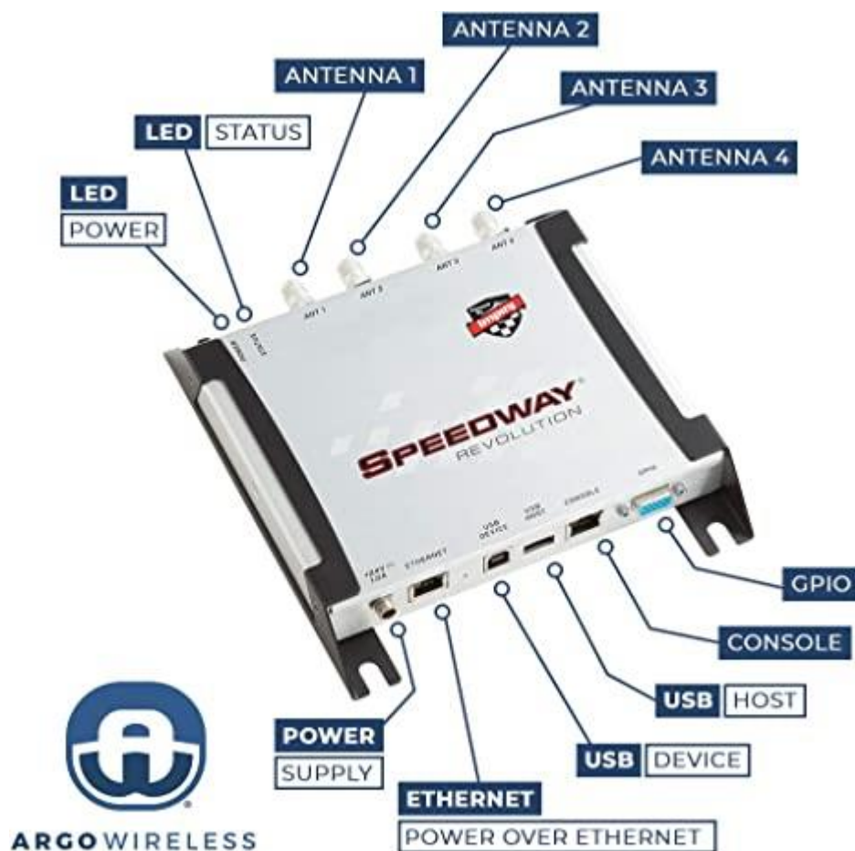
Figura 82. Partes del Reader Speedway Revolution 420. Fuente: Manual de usuarios del Reader Speedway Revolution 420 https://manuals.plus/es/impinj/ipj-rev-r420-speedway-reader-manual
