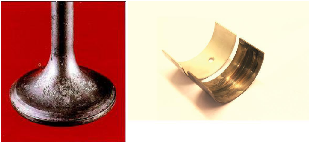
Ilustración 1 Corrosión ácida del cilindro y cojinete del motor
