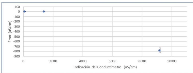
Figura 1.- Curva de calibración del conductímetro.
