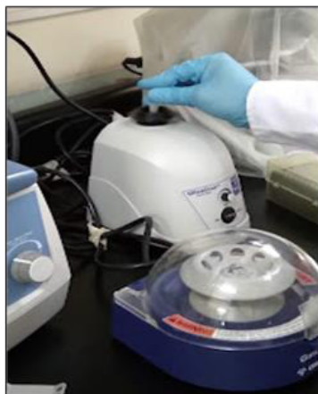
C) Colocación en vórtex por 30 segundos para homogenizar bien la mezcla
