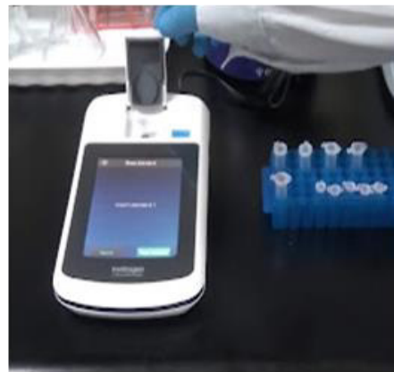
H) Lectura en el equipo Qubit4 Fluorometer
