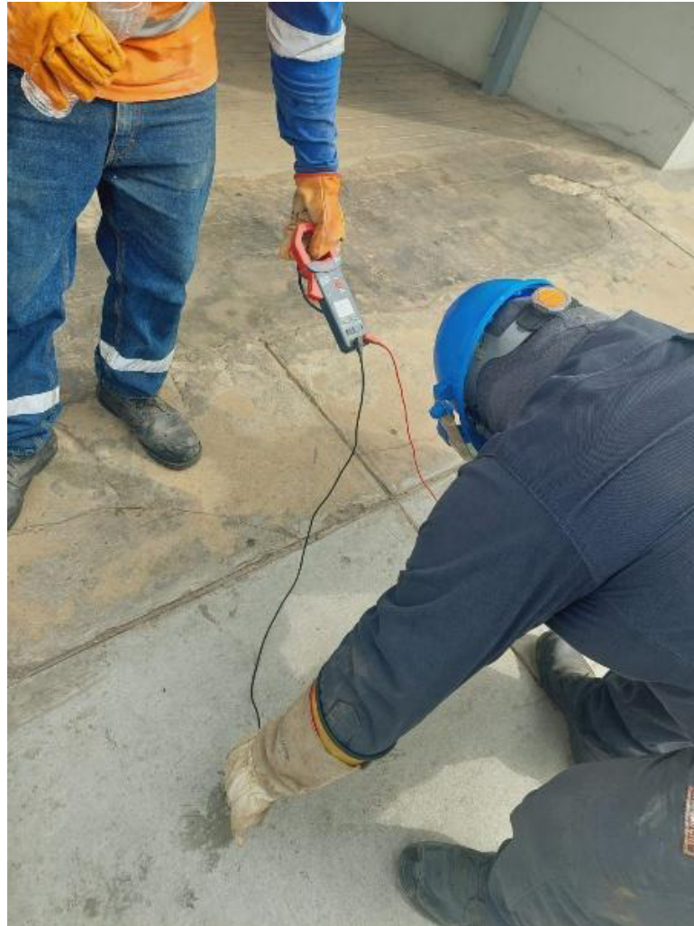
Figura 8. Tensión de paso. Elaboración propia
