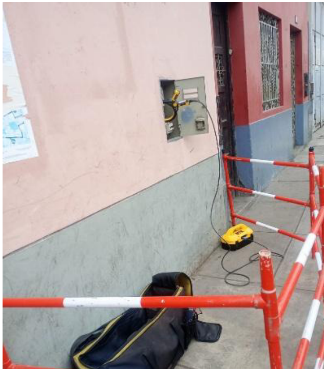
Figura 58. Uso de pinza inductiva. Elaboración propia
