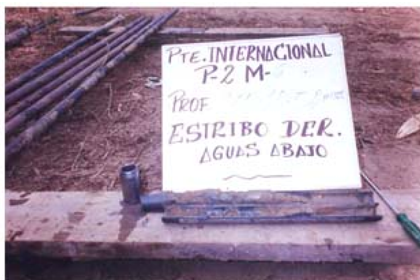
16.- Vista de las muestras extraídas de la margen derecha del Canal Internacional Aguas Verdes (P - 2), recuperadas en el tubo muestreador del (SPT). Se aprecian las muestras de suelos de naturaleza limoarcillosa y arcillosa, definida en laboratorio como (CL y ML ) respectivamente.
