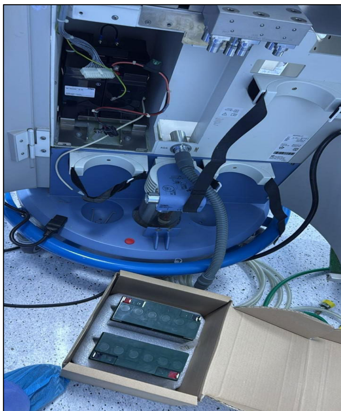
Figura 15 Imagen de cambio de repuestos a una máquina de anestesia. Fuente Elaboración propia (fotografía).
