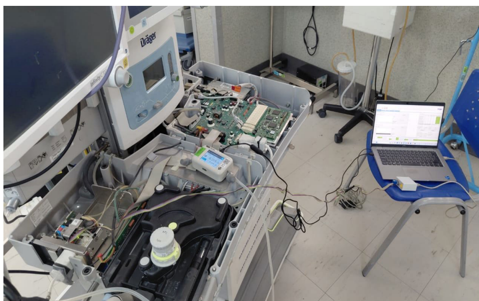
Figura B 2 Corrección de falla de analizador de gases. Fuente. Elaboración propia (Fotografía)
