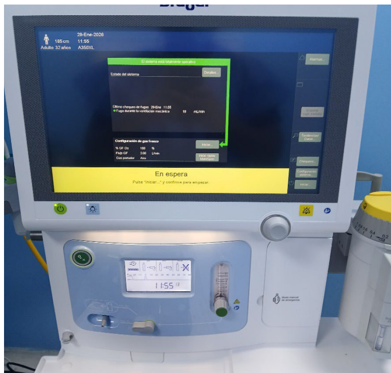
Figura B 4 Chequeo del equipo correcto después de intervención correctiva. Fuente. Elaboración propia (Fotografía)
