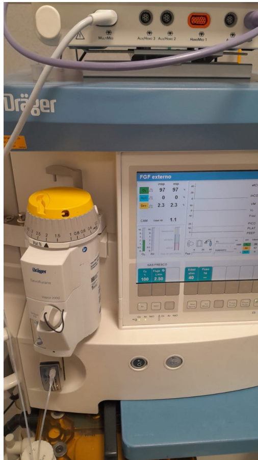
Figura A 12 Verificación del vaporizador. Fuente. Elaboración propia (Fotografía)
