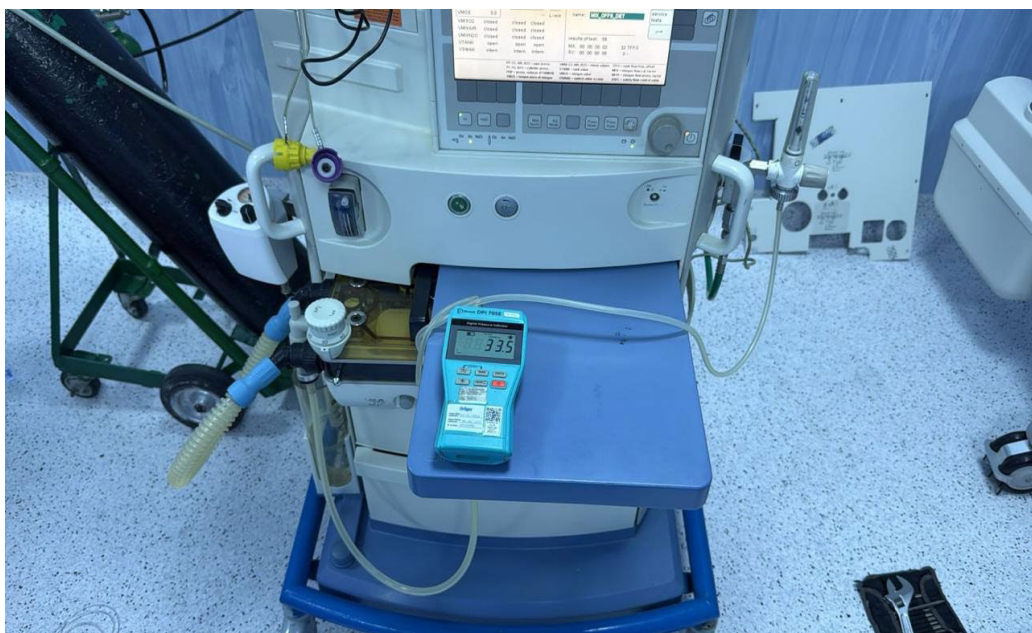
Figura A 5 Prueba de fugas del ventilador. Fuente. Elaboración propia (Fotografía)
