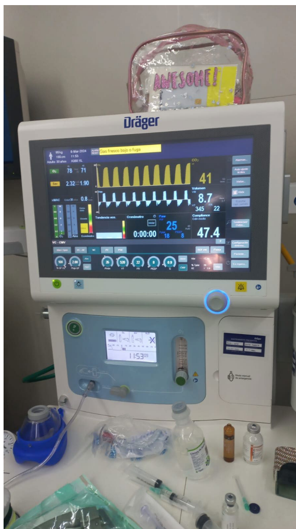
Figura A 9 Prueba de funcionamiento en modo ventilación. Fuente. Elaboración propia (Fotografía)
