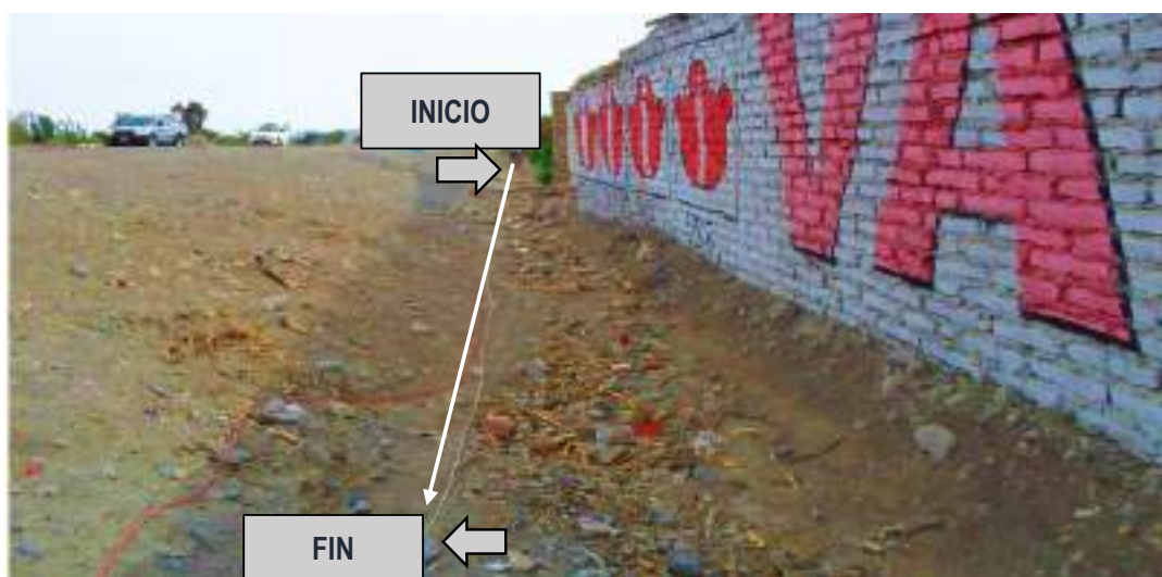
Fotografía 10: Cables extendidos y listos para realizar Ensayo de Refracción sísmica.
