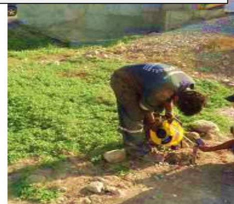
PERFORACIÓN P-04: INSTALACIÓN DE TUBERÍA PVC - MEDICIÓN DE NIVEL FREÁTICO
