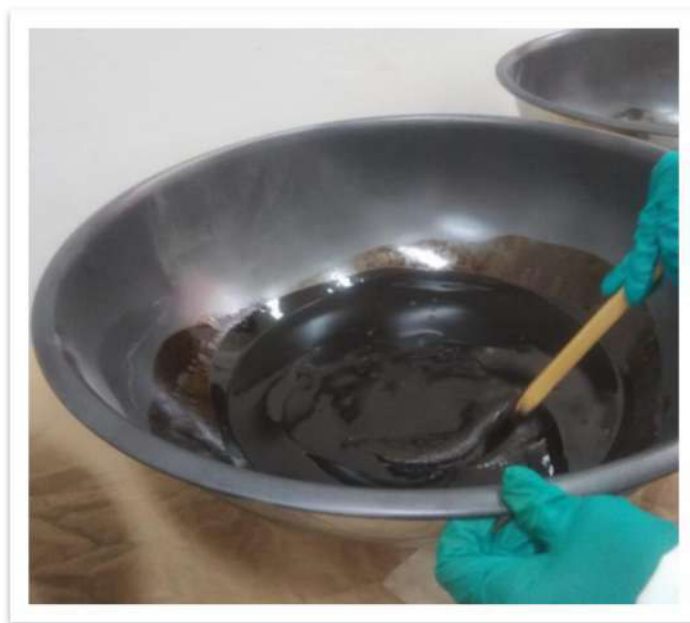
Figura 10. Terrario de acero inoxidable que contiene suelo arenoso, petróleo crudo, consorcio bacteriano y agua.
