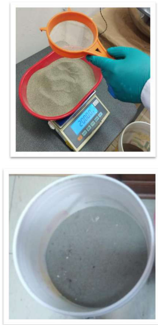
Figura 9. Medición de la masa y tamizado de suelo arenoso costero para obtener una muestra homogénea.
