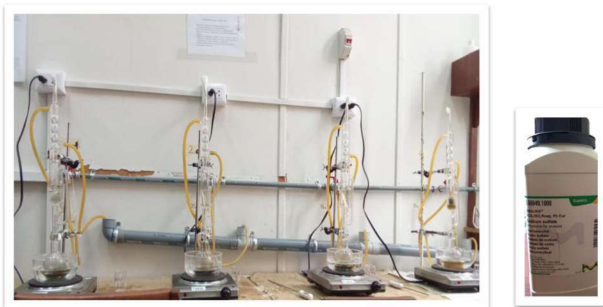
Figura 13. Equipo extractor Soxhlet, marca Eurolab, de extracción de hidrocarburos y sulfato de sodio anhidro.
