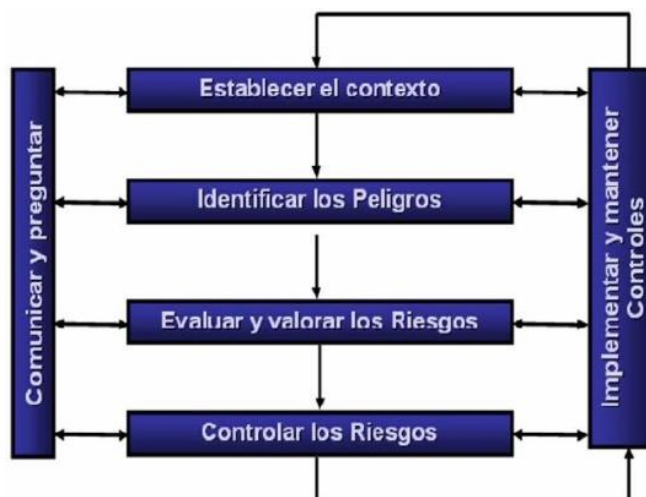
Figura 46. Diagrama de Flujo del Proceso de Gestión de Riesgos. Fuente. Análisis IPER para trabajos con tensión, Darwin Padilla Gutiérrez –Año 2019.
