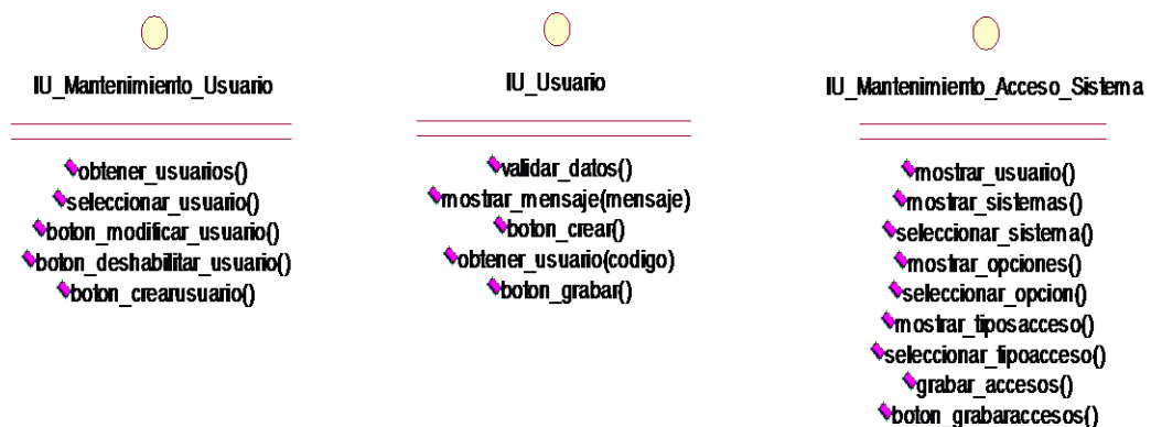
Figura 4.15: Diagrama de Clases interfaz del módulo de gestión de usuarios
