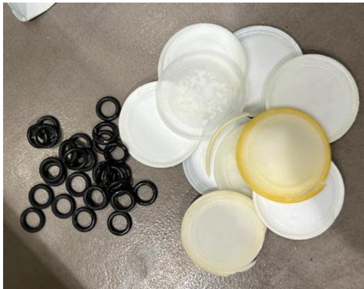
Figura 2 Orings y capuchones de botellas deteriorados
