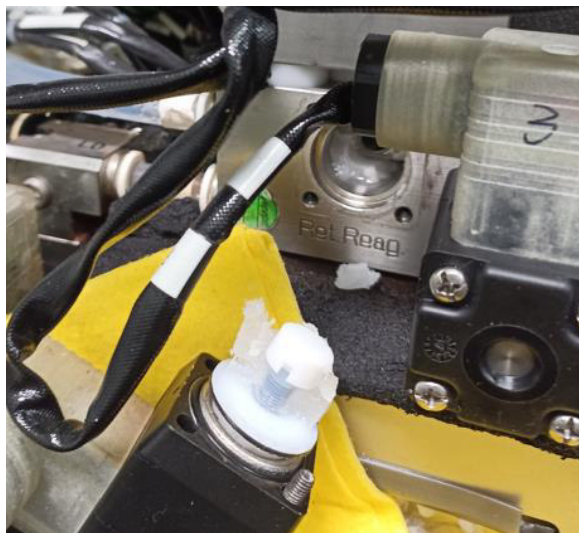
Figura 12 Válvula de reactivo con presencia de parafina sólida
