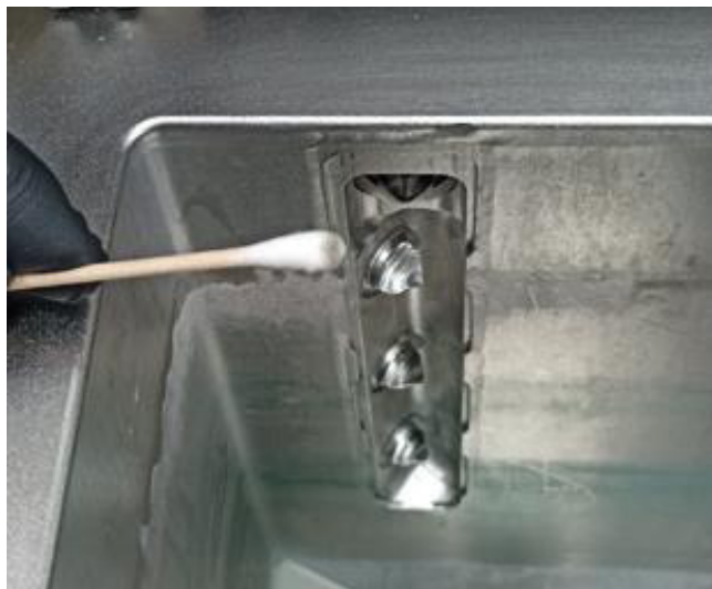
Figura 6 Limpieza de los sensores de nivel
