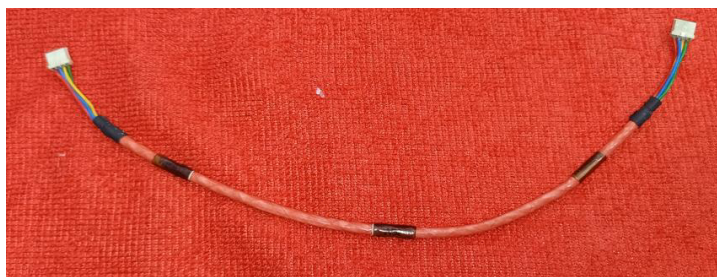
Figura 14 Cable de sensor de temperatura dañado
