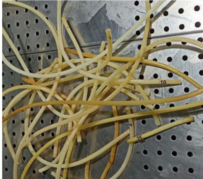
Figura 3 Tuberías de aire taponadas con parafina
