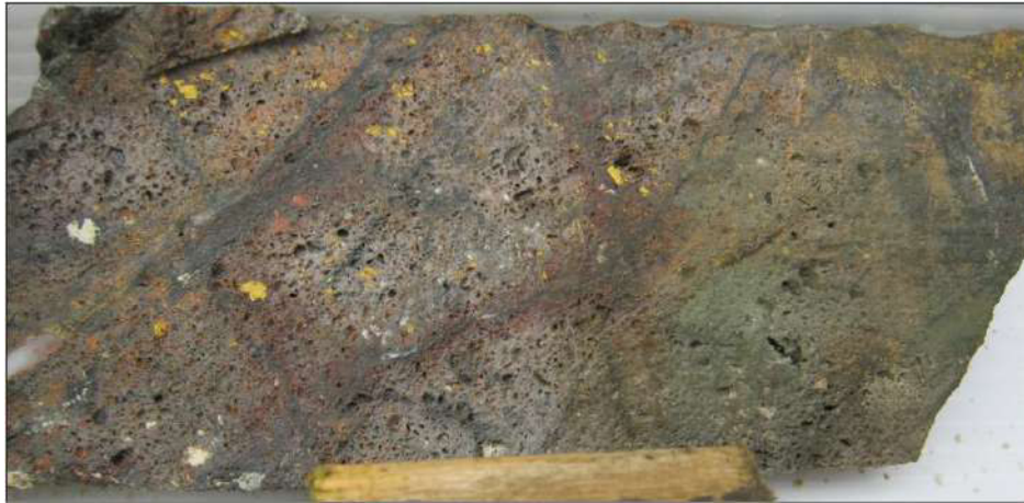
Figura 30. Cuarzo residual vuggy localmente desarrollada en feeders de la alteración argílica avanzada, con protolito de andesita porfírica. Las oquedades están parcialmente rellenas con pararejalgar y se observan remanentes de vetillas de cuarzo lixiviadas.
