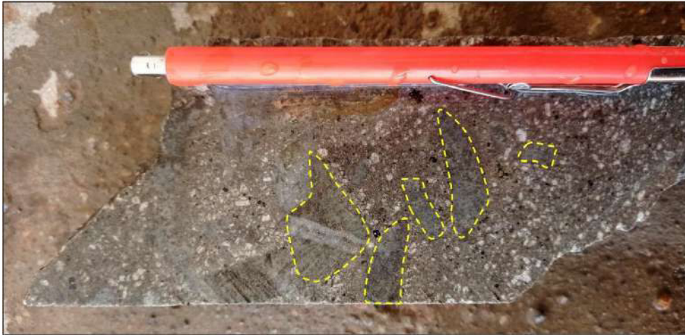
Figura 26. Dique diorítico intermineral con clastos redondeados de un pórfido temprano(?) que tiene vetillas tipo “AB” con sutura de pirita-calcopirita.
