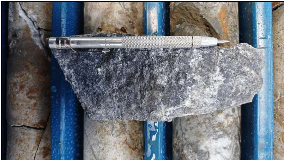
Figura 42. Muestra de sondaje con smear molybdenite en fracturas.
