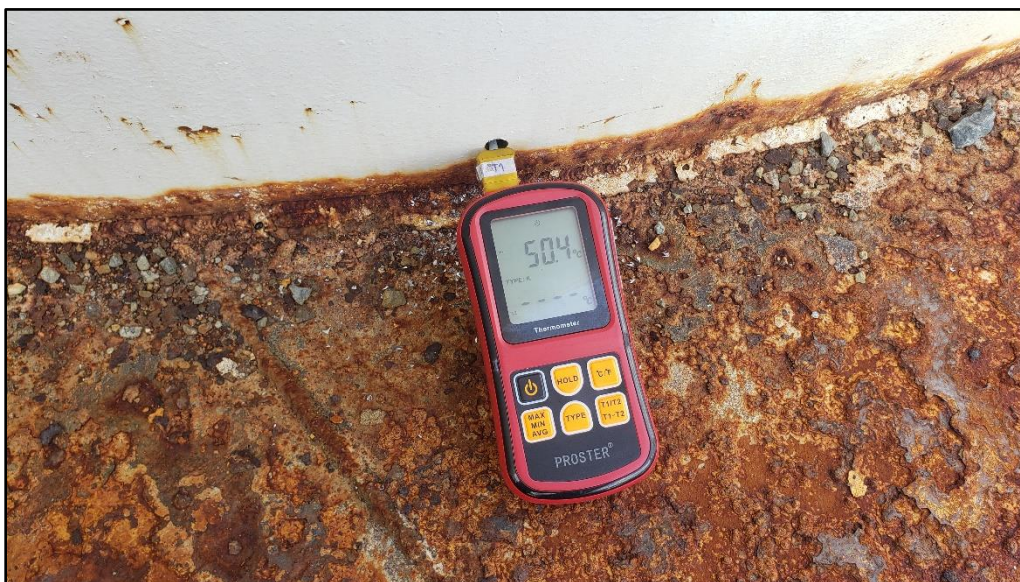
Figura 27: Medición de temperatura de flujo de aire en salida – RB_2.
