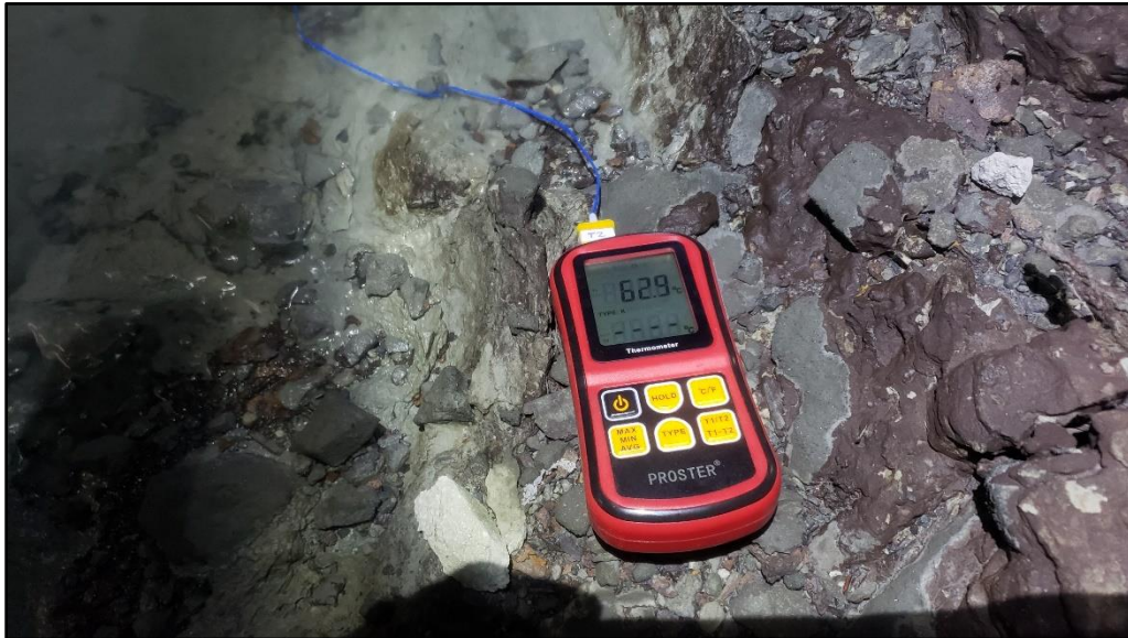
Figura 37: Medición de temperatura de agua en poza de bombeo.
