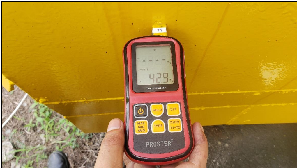
Figura 23: Medición de temperatura de flujo de aire en salida – RB_1.
