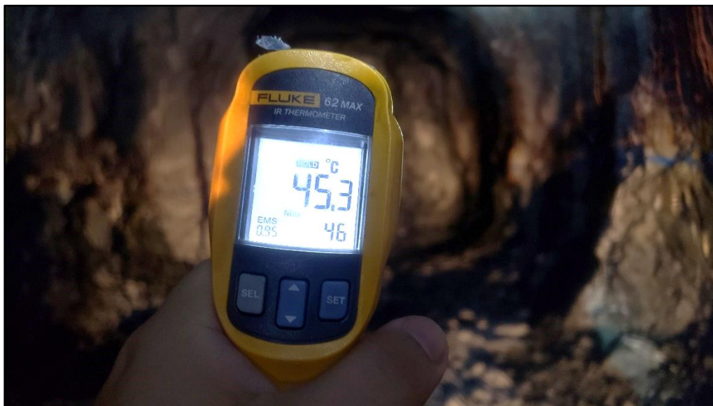
Figura 30: Referencia de medición de temperatura de macizo rocoso - Frente de exploración.
