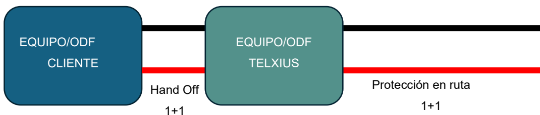
Figura 8: Extremo de circuito protegido con Hand Off 1+1
