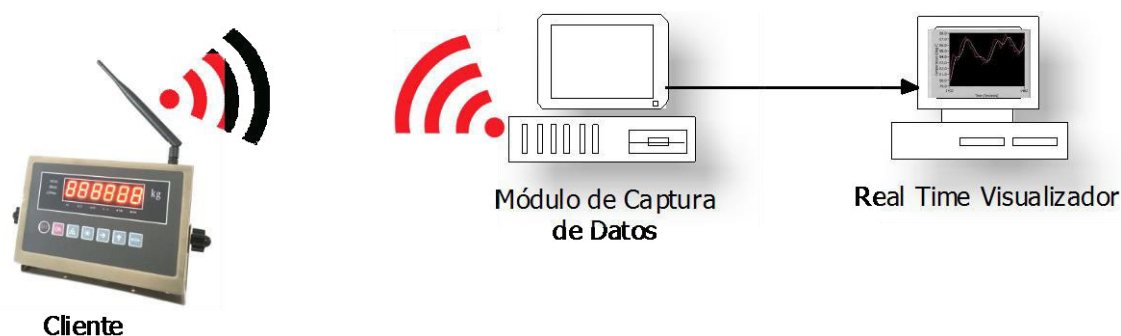
Figura 29: Diagrama Esquemático del módulo de Visualización o Monitoreo
