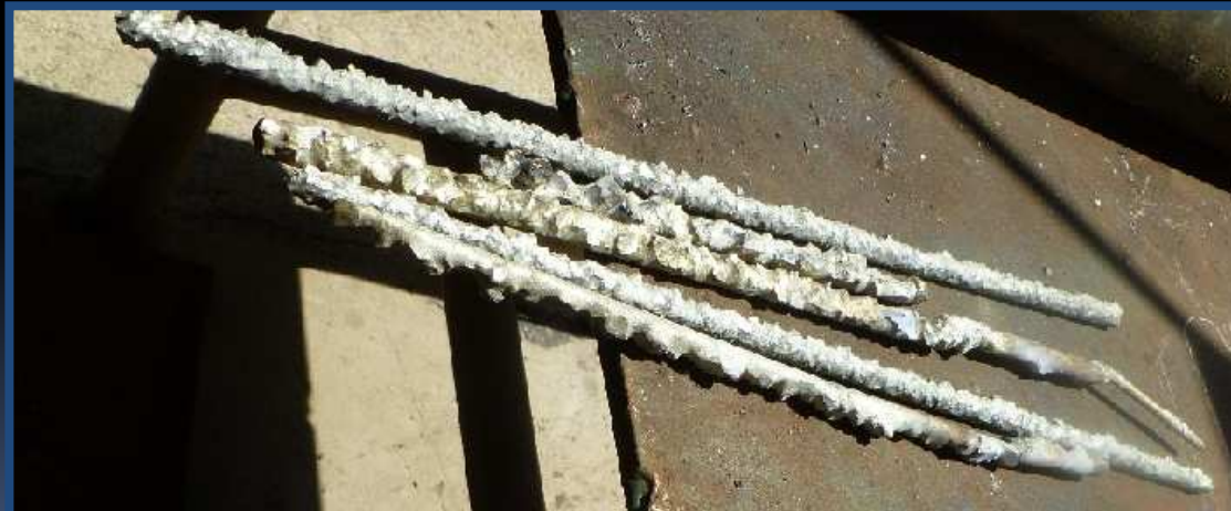
Varillas de Carburo de Tungsteno en matriz de bronce.
