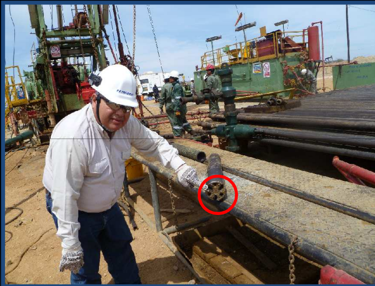
Trepano desgastado que va a reparación
