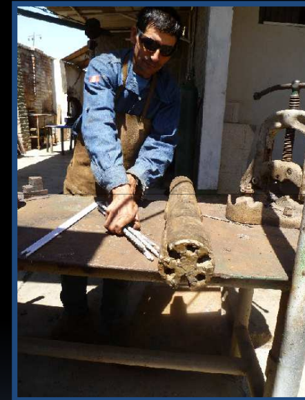
Paso 1. Acomoda trépano a reparar en mesa de trabajo
