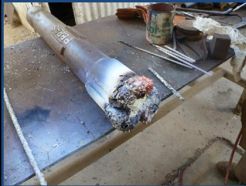
Paso 08: Aplicación de soldadura de bronce e insertos de Carburo de Tungsteno
