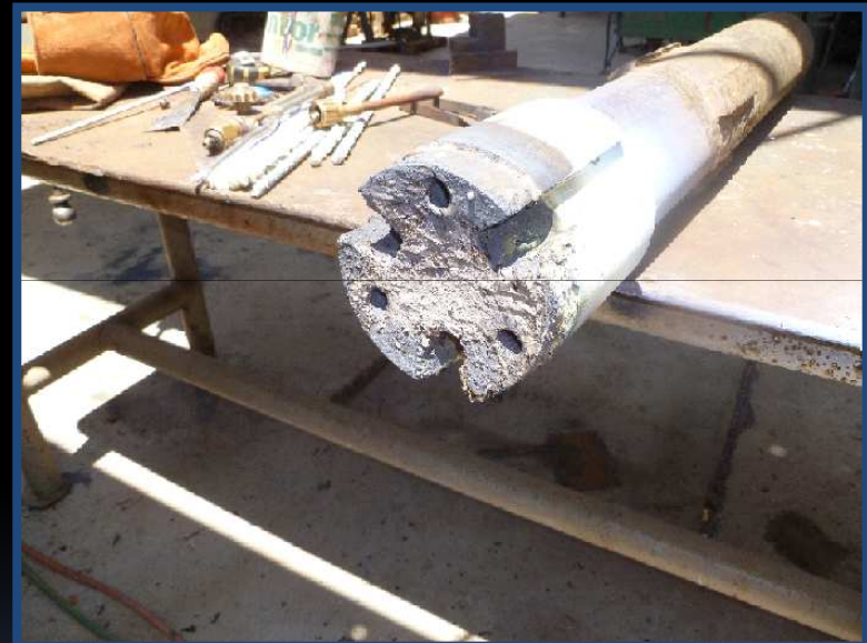
Junk Mill - Trépano libre de material fatigado
