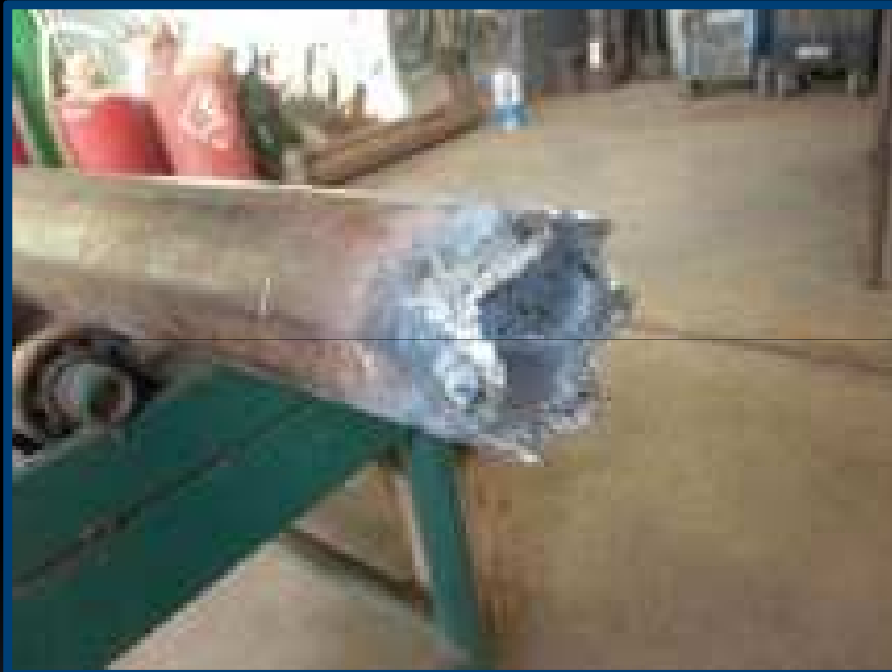
Zapato Lavador reforzado con Carburo de Tungsteno.
