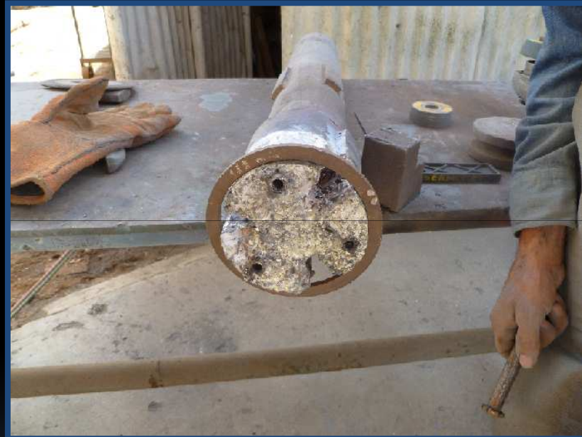
Junk Mill reparado con Carburo de Tungsteno.
