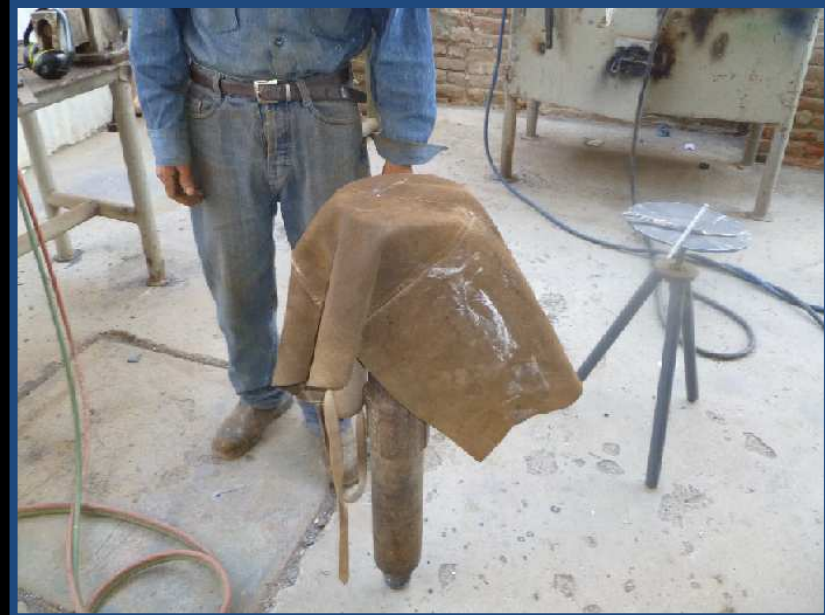
Paso 09: El trépano es cubierto para su enfriamiento lento durante 18 horas al aire libre.
