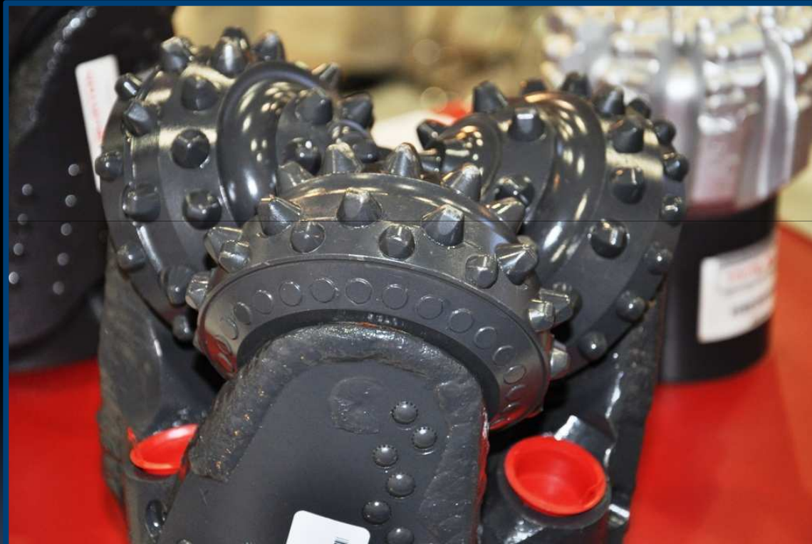
Broca tricónica con insertos de Carburo de Tungsteno.
