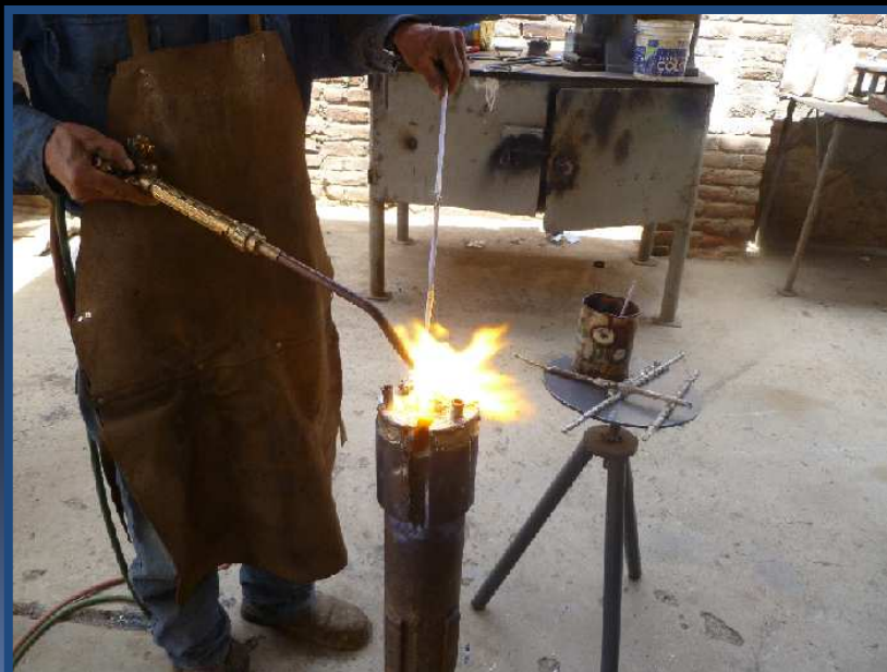
Paso 07: Acomodando los insertos de Carburo de Tungsteno con soldadura de relleno de bronce niquelado.
