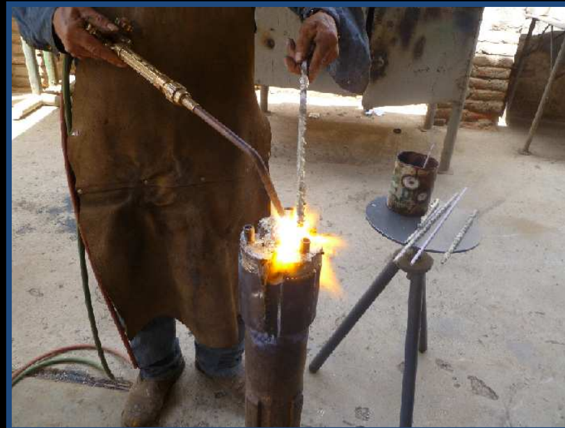
Paso 06: Se deposita inserto de Carburo de Tungsteno en soldadura de bronce niquelado, aplicado en matriz.
