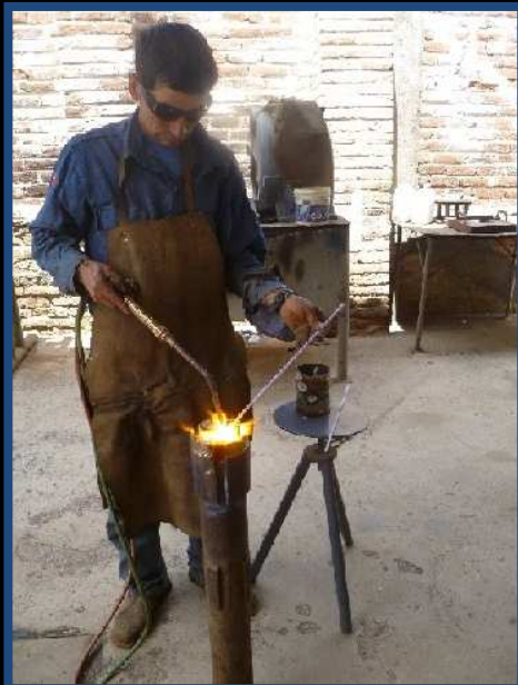
Paso 05: Aplicación de soldadura de bronce niquelado en matriz del trépano.
