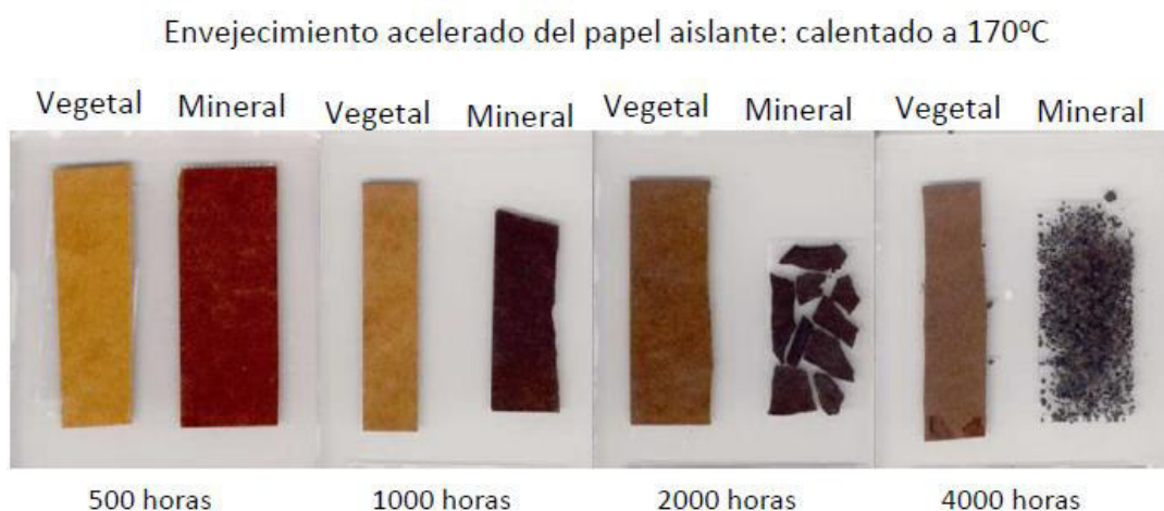
Figura 14. Envejecimiento acelerado, Fuente: Aplicación de Aceite Vegetal en Transformadores-cargill - Agosto 2019.Pdf.
