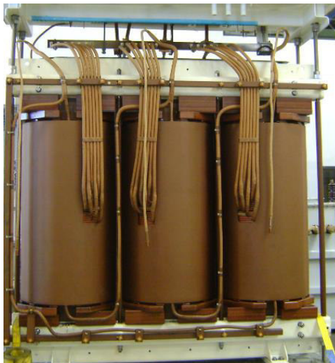
Figura 7. Celulosa de transformador de potencia, extraída:
