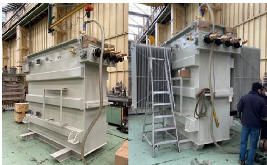
Figura 40. Proceso de vacío y envasado a transformador de potencia 15MVA,
