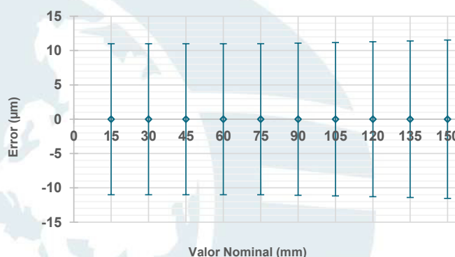
Figura 1. Error vs. valor nominal para la medición de exteriores
