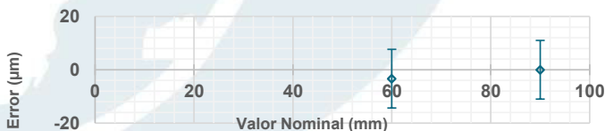
Figura 2. Error vs. valor nominal para la medición de interiores.
