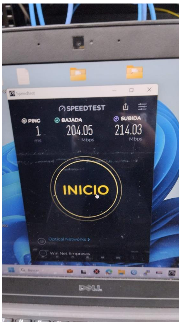
Figura 36: Medición de ancho de banda en la Sede Remota 4. Fuente. Imagen proporcionada por Win Empresas durante la fase de validación de ancho de banda.
